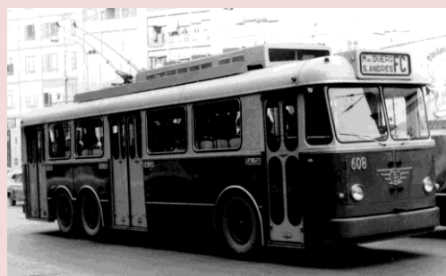
BUT 608 ya reformado a un piso
