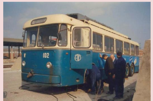
Montando la rueda y comprobando el palier
